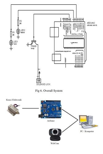
Fig 7. Diagram Blok
